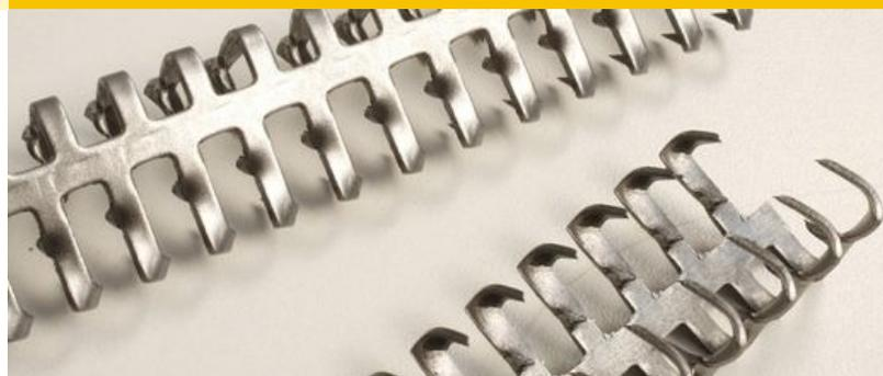
O Grampo Fera Guará é indicado para realizar uniões em correias de transmissão de potência ou transportadoras operando sem abaulamento e com cargas leves ou médias. Permite abrir a correia no local da emenda para limpeza ou manutenção do transportador, apenas removendo-se a cavilha de articulação do grampo. Utilizado em correias operando em linhas de correios, depósitos, aeroportos, na indústria têxtil, alimentícia, de cigarros, de equipamentos agrícolas ou de produtos químicos e borracha.
