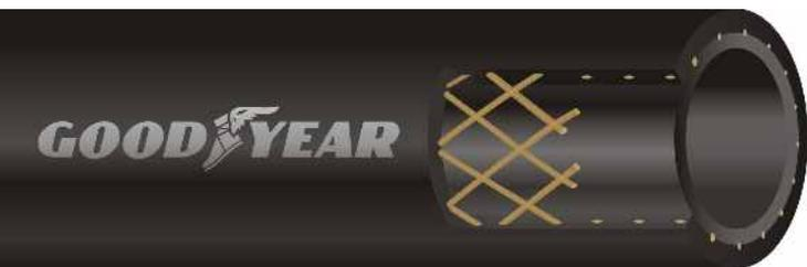
**Aplicação:** Indicada para serviços pesados, linhas de compressores, serviços de jateamento de água e ar industrial, construção civil, agrícola e outras aplicações com boa resistência a óleo. Não condutiva, podendo ser usada em aplicações que requerem alta isolamento (resistência elétrica de 1 megaohm por polegada até 1.000VDC).
